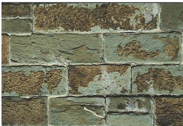
Grès de Sillery (ou Cap-Rouge): maçonnerie de parement et photomicrographie (13x).
